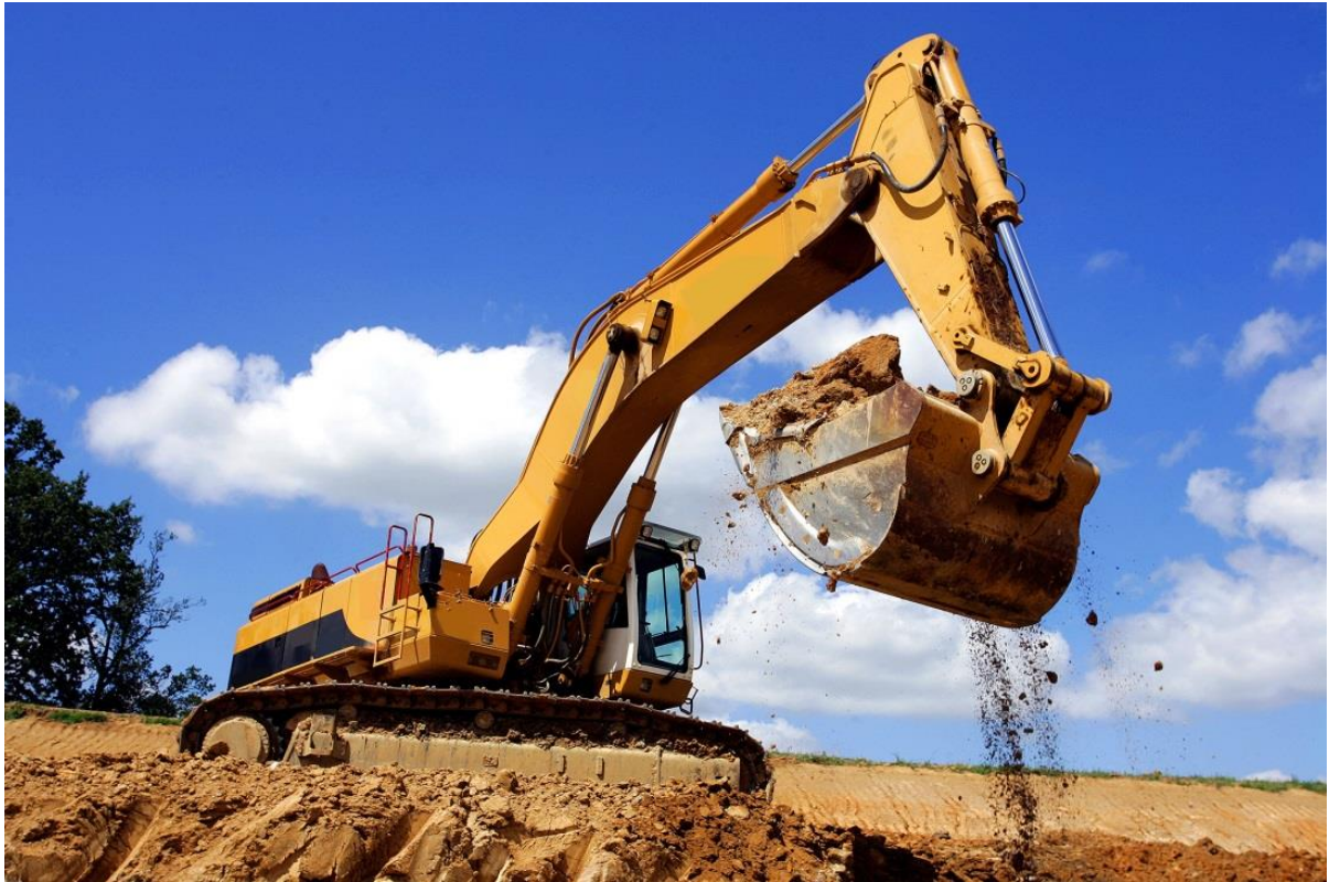
รูปที่ ๑-๘ รถขุดไฮดรอลิกแบบบั้งก็่ดักเข้า
