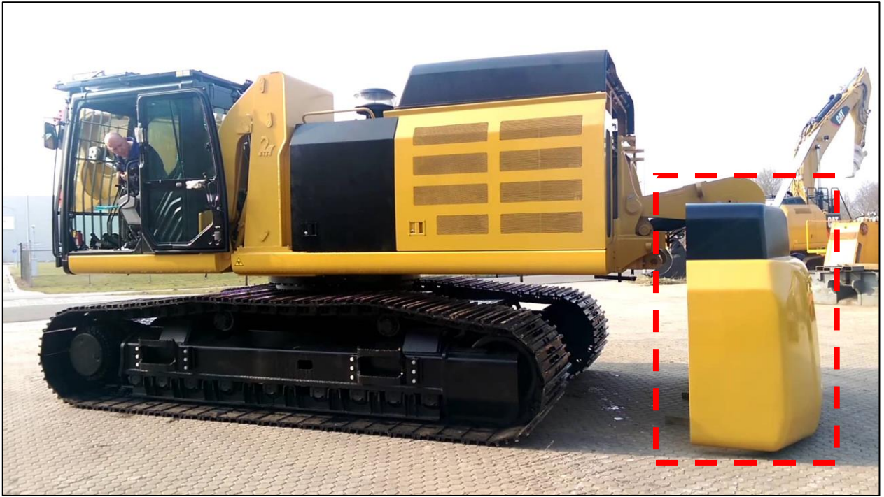
รูปที่ ๓-๘ น้ำหนักถ่วง (Counter weight) ของรถขุด
