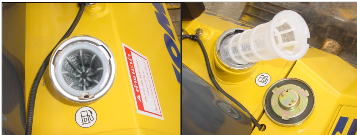
รูปที่ ๓-๖ ถังน้ำมันเชื้อเพลิงรถขุด
