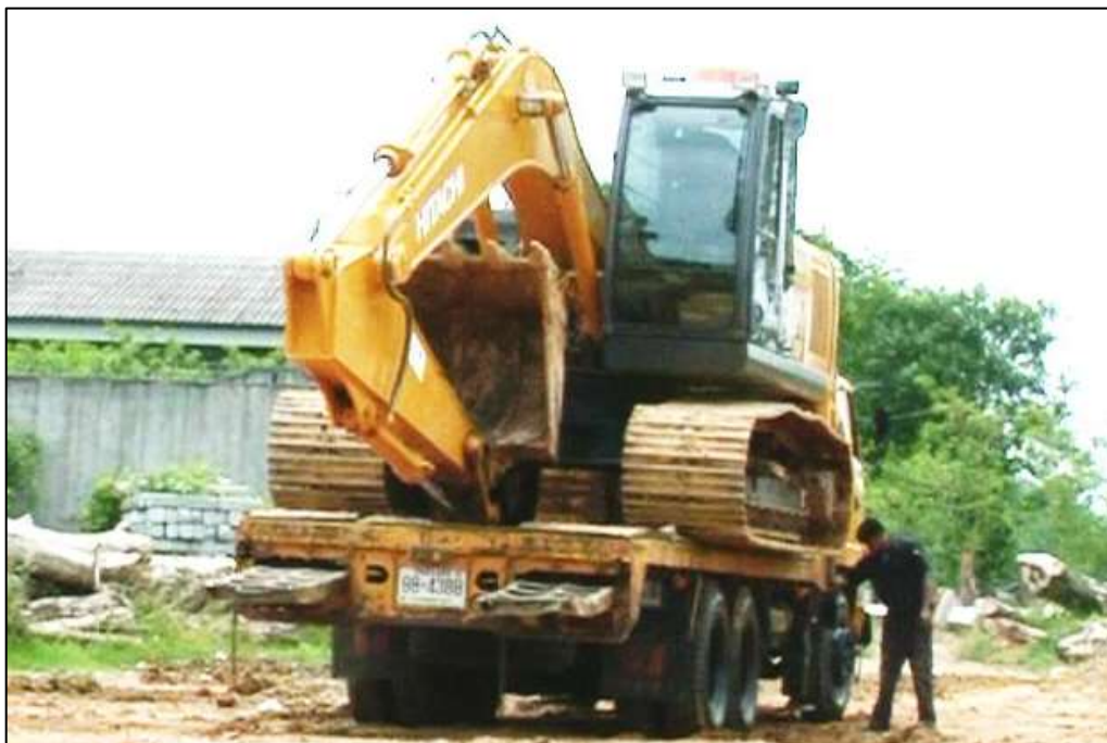
รูปที่ ๔-๔๕ การขึ้นลงรถบรรทุกเครื่องจักรกลของรถชุด
