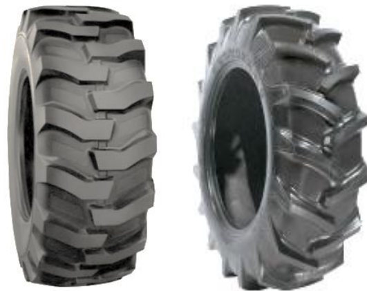
รูปที่ ๓-๒๕ ยางสำหรับพื้นโคลนและดินอ่อนนุ่ม (Traction) ใช้กับล้อที่ขับเคลื่อน
