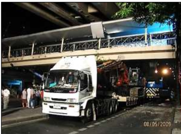
รูปที่ ๔-๕๖ อุบัติเหตุที่เกิดจากการบรรทุกเครื่องจักรผ่านเส้นทางที่มีความสูงจำกัด
