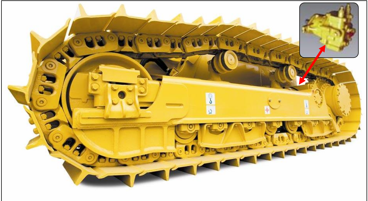
รูปที่ ๓-๑๖ มอเตอร์ไฮดรอลิกขับเคลื่อนมอเตอร์เดิน (Travel Motor) ของรถขุด
