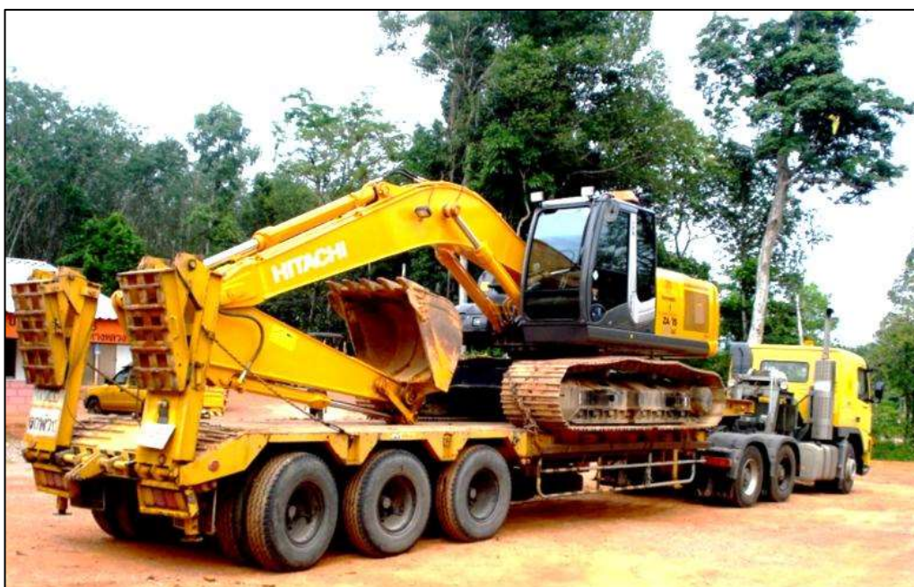
รูปที่ ๔-๔๖ รถชุดที่อยู่บนรถบรรทุกพร้อมทำการขนส่ง
