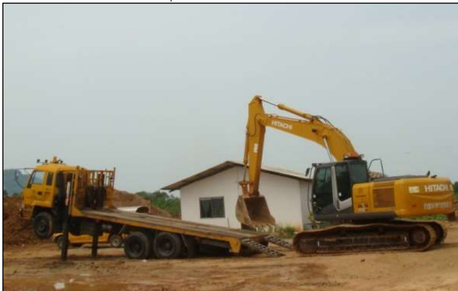
(๒) รถบรรทุกเครื่องจักรแบบ ๑๐ ล้อมีบันไดลาดชัน รูปที่ ๔-๔๐ รถบรรทุกเครื่องจักรที่มีบันไดลาดชัน
