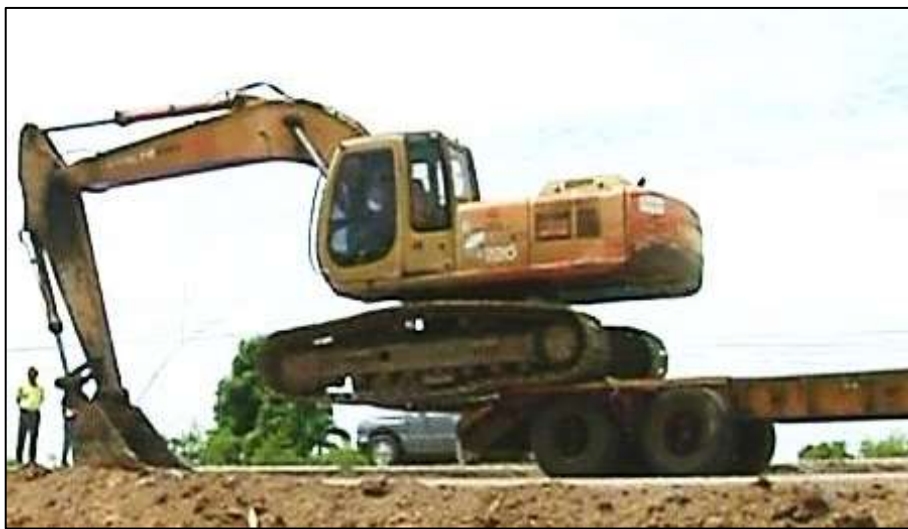
รูปที่ ๔-๕๑ การขึ้นลงรถบรรทุกเครื่องจักรกลของรถชุด
