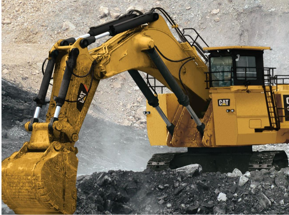
รูปที่ ๑-๑๒ รถขุดไฮดรอลิกขนาดน้ำหนัก ๓๐ ตัน ขึ้นไป
