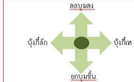
รูปที่ ๔-๒ การบังคับคันควบคุมรถขุดไฮดรอลิกตีนตะขาบ Hitachi รุ่น ZX๑๘๐LC
